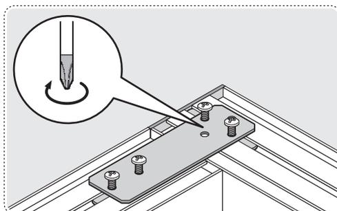
**4** Совместить отверстия соединительных пластин и закрепить их винтами между собой
